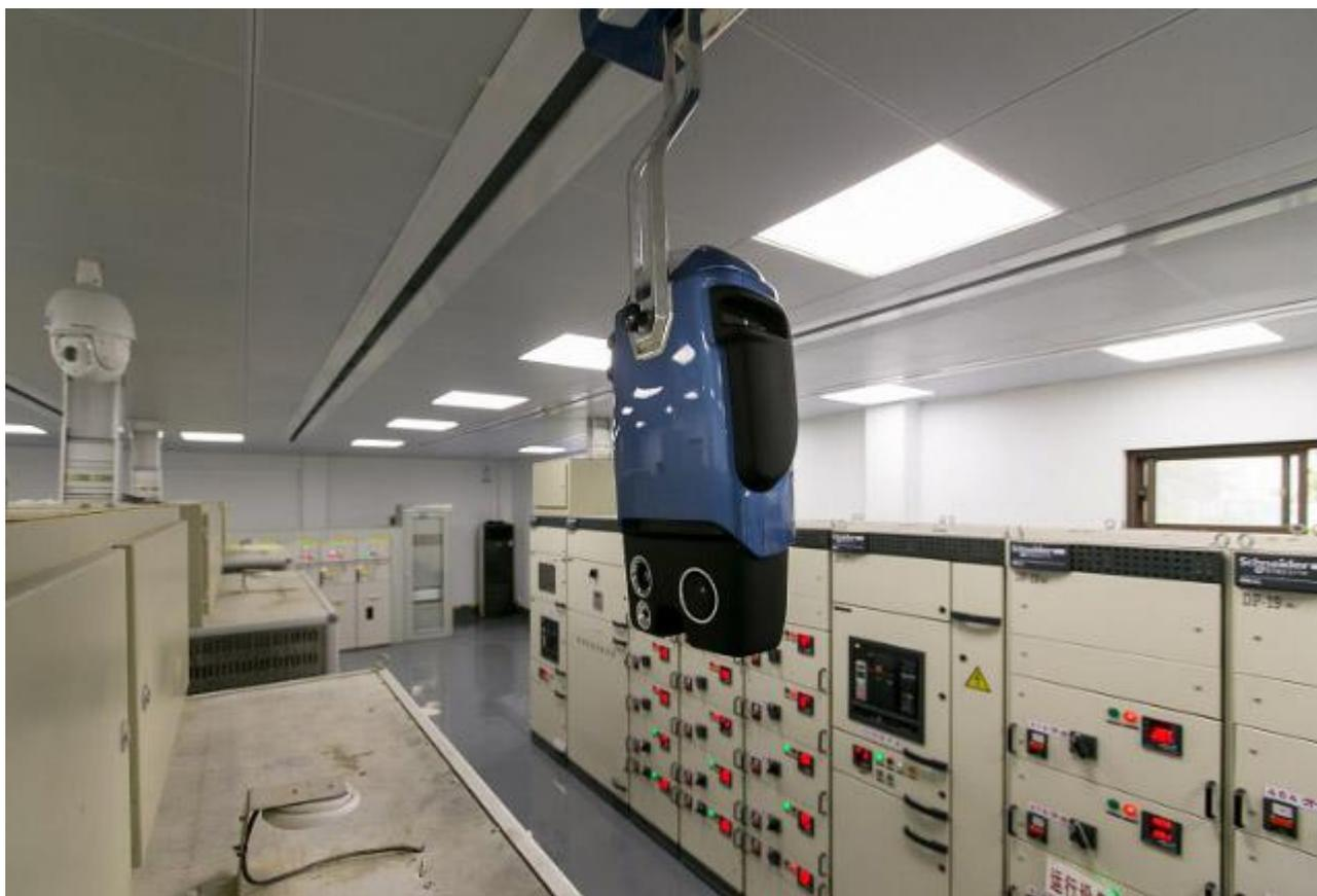
目前，巡检机器人中使用的数据传输方式有 WiFi、网络和电力载波。WiFi 存在着传输不稳定、数据延时大、时常掉线连接的问题。网络布线技术要求工程一开始就把所有布线完成，否则需要重新开槽、打墙，走线成本将非常高昂。电力载波通信（PLC）可以利用现有电力线，不需要重新架设网络，信号稳定、高传输速率、抗干扰性强、免布线烦恼、即插即用。应用电力载波通讯技术，进行音视频、控制指令和系统状态等信息的传输，可以做到整个通信过程的准确无
